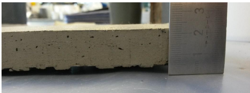
Figura 5 – Misura della concavità ai bordi estremi del campione
