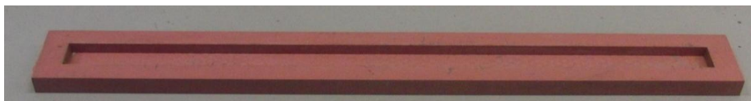
Figura 1 – Attrezzatura per la verifica qualitativa della capacità di espansione
