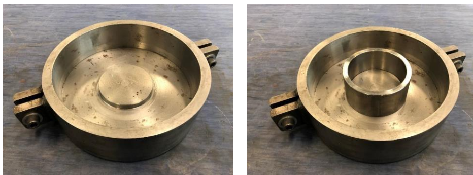
Figura 6 – Cassero in ferro per O-Ring test, senza e con anello centrale
