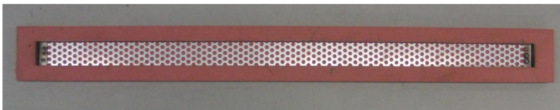
Figura 2 – Attrezzatura per la verifica qualitativa della capacità di espansione
