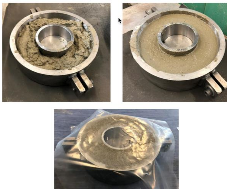
Figura 7 – Preparazione del provino
