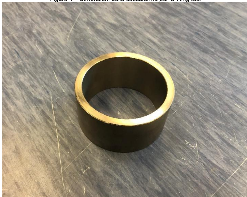
Figura 5 – Anello metallico interno per O-Ring test
